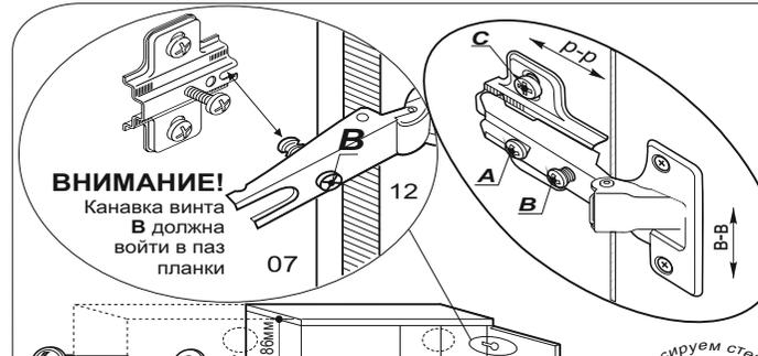
Для плотного примыкания шкафов один к другому предусмотрена стяжка MVTON2950. Вертикальные щиты шкафов имеют по два недосверленных отверстия Ш 5мм. глубиной 16мм. Прокोलите шилом насквозь эти
